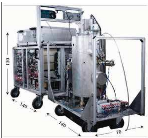
Figure 3 : Gravimètre transportable développé par le laboratoire SYRTE. Les dimensions sont en centimètres.
